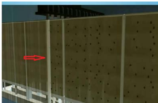
Рис. № 10. Движение каретки с полыми стержнями Рис. № 11. Насос откачки взвешенных веществ
