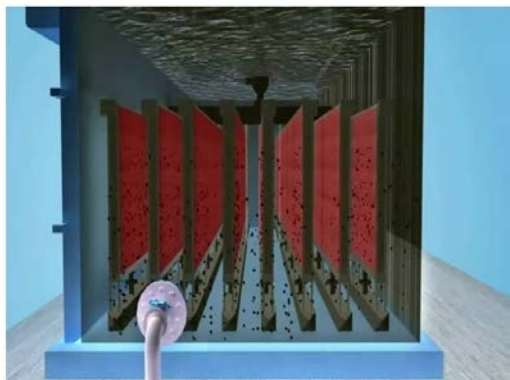
Рис. № 8. Подвод очищенной воды с аэротенков Рис. № 9. Откачка отфильтрованной воды
