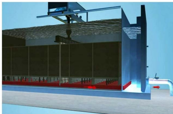
Рис. № 8. Подвод очищенной воды с аэротенков Рис. № 9. Откачка отфильтрованной воды
