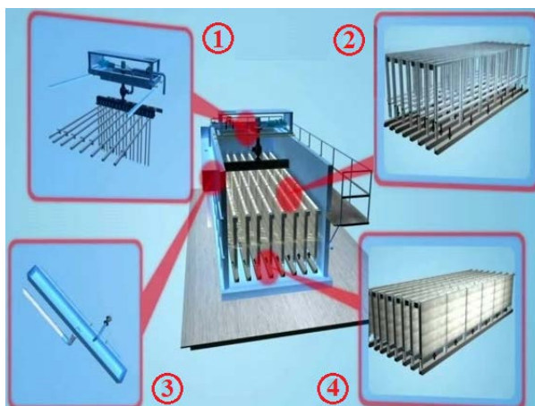
Рис. № 07. Основные элементы конструкции 7.1 - Каретка с насосом откачки взвешенных веществ и активного ила вынесенного из ВО; 7.2 - Жесткий каркас для СВТ; 7.3 - Лоток для слива стока соединенный с ВО; 7.4 - Панельный каркас с тканевым фильтром;
